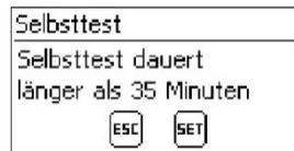
Langes Drücken von "SET" startet den Selbsttest. Während der Selbsttest läuft, werden auf dem Display die gemessenen Werte angezeigt.
