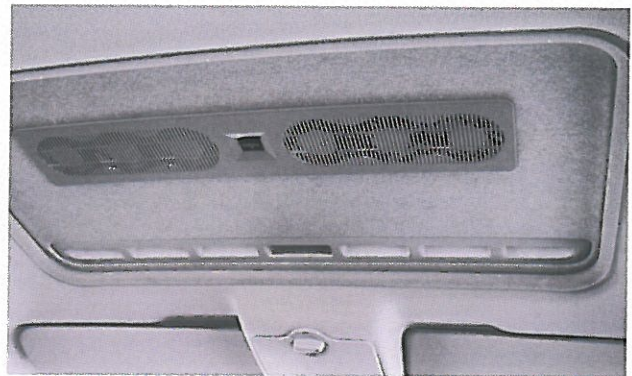
Schiebehimmel mit Lüfterkaskade
