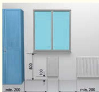
Schematischer Aufbau bei monolithischer Bauweise. Bei Wärmedämmverbundsystemen und Holzständerbauweisen ist die Einbautart entsprechend dem Wandaufbau anzupassen.
