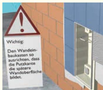
Stellen Sie sicher, dass die Putzleiste die tatsächliche spätere Wandvorderkante bildet. Es dürfen max. 13 mm Abstand zwischen Wandeinbaukasten und späterer Wandoberfläche entstehen. Zum Schluss ist das Lüftungsgerät im Wandeinbaukasten zu montieren.
